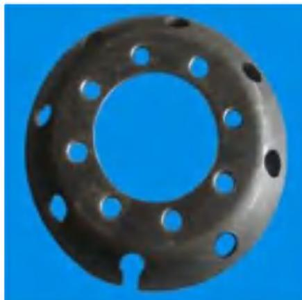
图 4.1-4 汽车轮辐构造图
