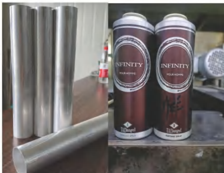
图 3.1-3 产品样品照片（左图为电池壳，右图为气雾罐）
