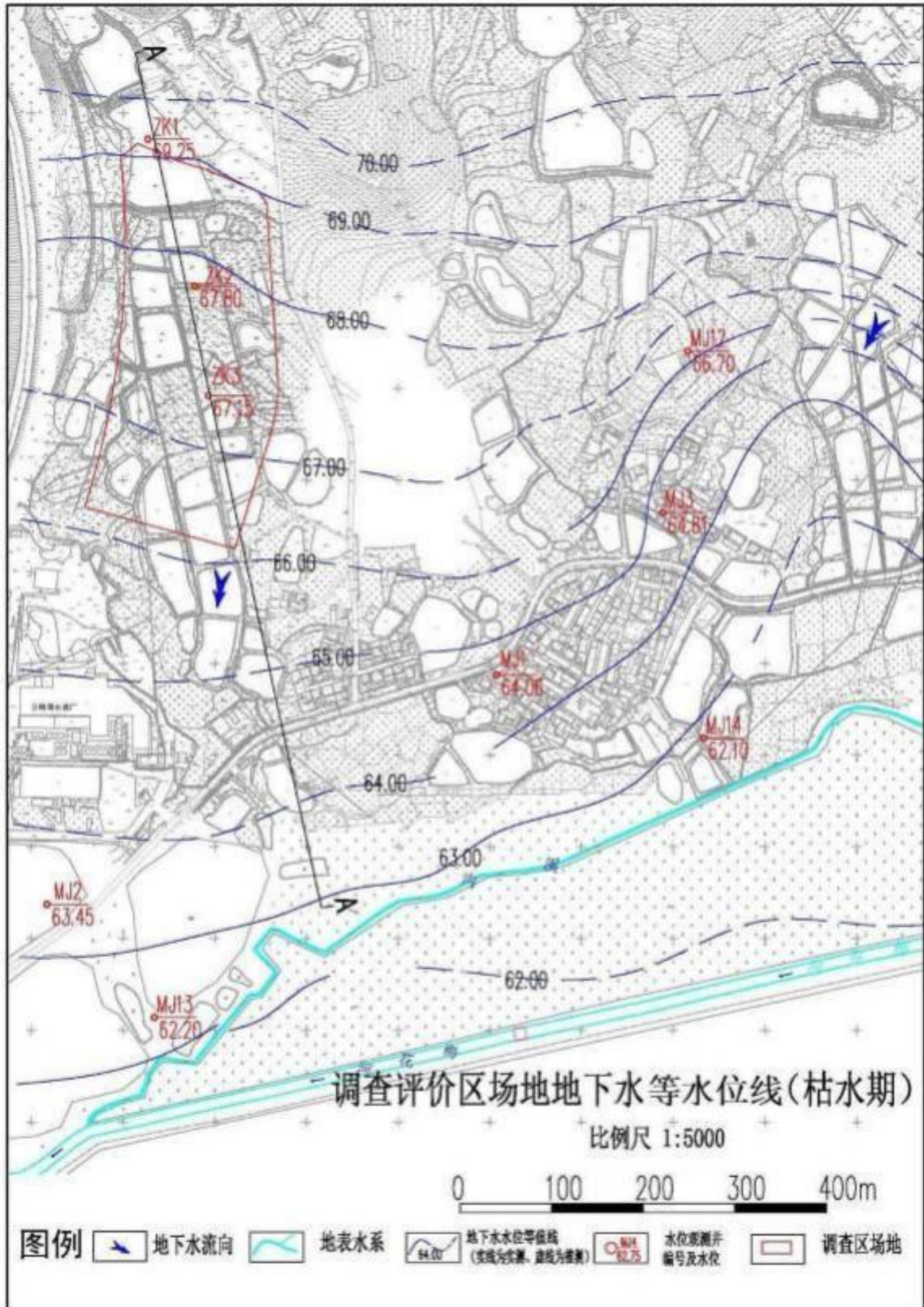
图6.5-3地下水等水位线图（枯水期）
