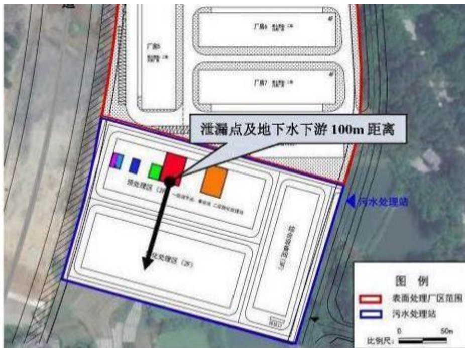
图 6.5-10 泄漏点位置及地下水下游距离示意图
