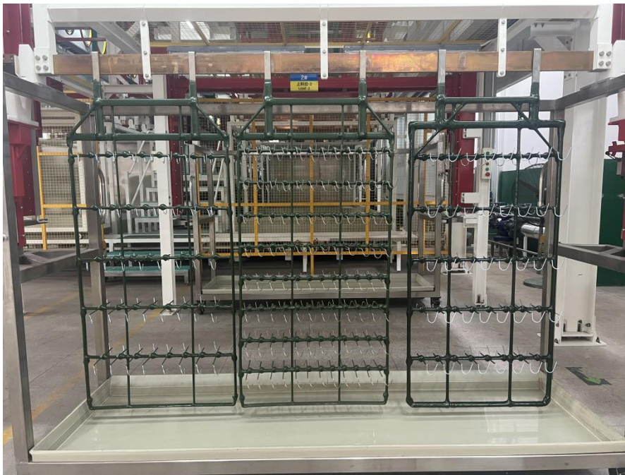
图 4.1-3挂具布置示例图
